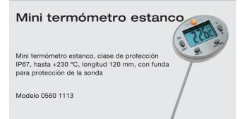
Después de medir, por ejemplo, en alimentos crudos o cocinados, el mini termómetro estanco se puede lavar directamente bajo el grifo o en el lavavajillas.
