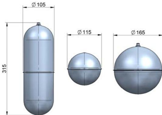
La selección del flotador para cada aplicación se realiza en función de las condiciones específicas para dicha aplicación, como son la densidad del líquido y la altura a medir.
