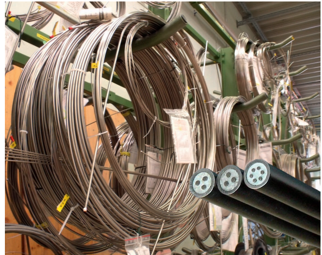
Cable con aislamiento mineral (cable MI)
