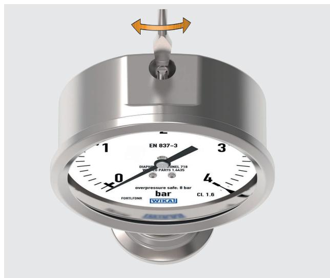
El ajuste del punto cero se puede hacer con un destornillador plano tras quitar el tapón de obturación en la parte superior de la caja.
