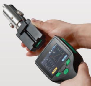
Fácil cambio del módulo del sensor a través del módulo deslizante con conexión automática
