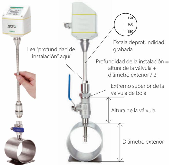
S401 se puede instalar bajo presión a través de una válvula de bola de 1/2". La punta del sensor debe estar en el centro de tuberías
