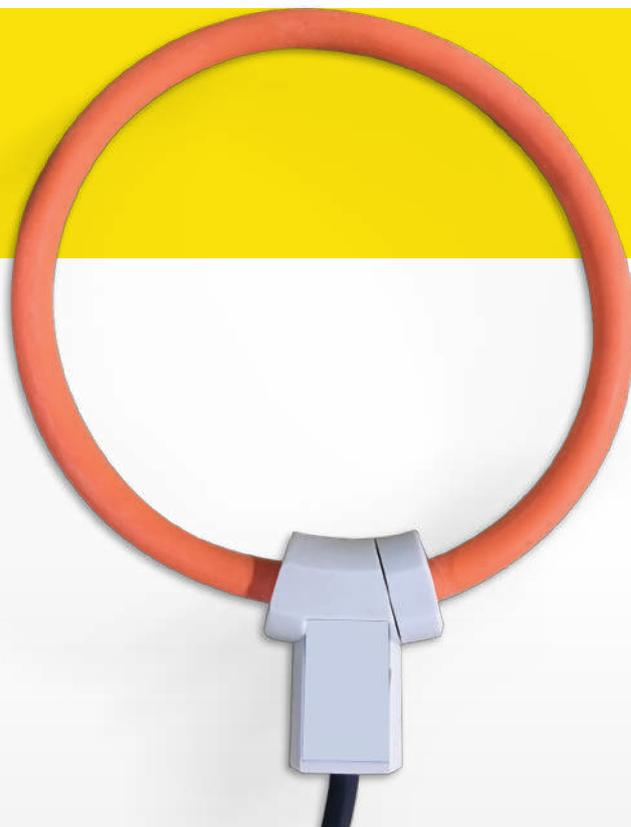
El sensor de corriente SUTO, es un sensor de corriente AC RMS compuesto por una parte activa flexible (bobina Rogowski) capaz de medir hasta un valor de 3000 A AC.
