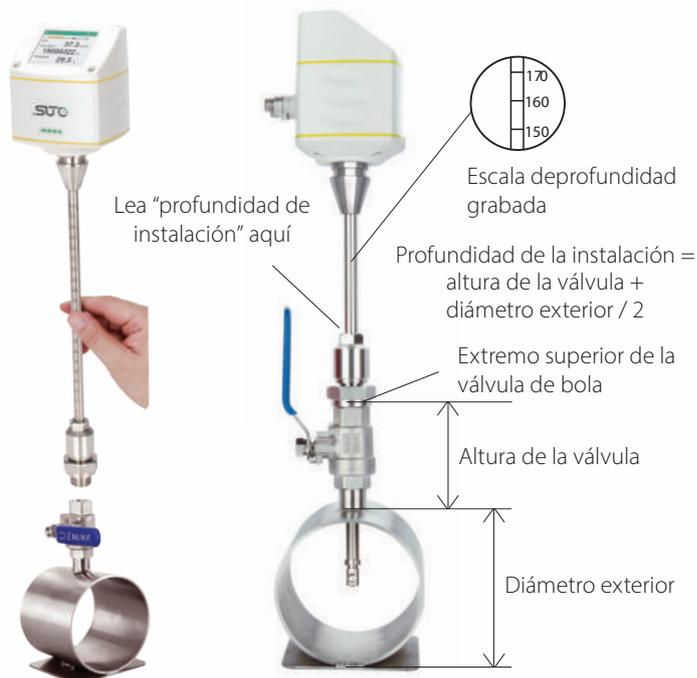
S401 se puede instalar bajo presión a través de una válvula de bola de 1/2". La punta del sensor debe estar en el centro de tuberías
