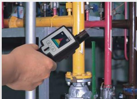
Detección de fugas a distancia con el puntero láser integrado
