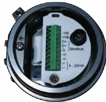
Terminales de tornillo con etiquetas de señal dentro de la cámara de conexión
