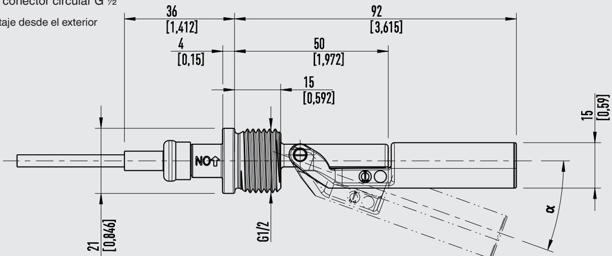
Punto de conmutación para la posición angular  $\alpha = 12^\circ \pm 4^\circ$
