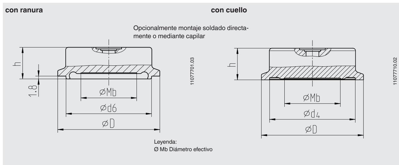
Norma de tubo: tubos según DIN 11866 serie A o DIN 11850 serie 2
