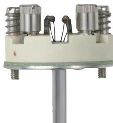
Prestar especial atención durante el montaje/desmontaje de la unidad de medida extraíble. ¡La superficie del cable encamisado de la unidad de medida extraíble no debe estar dañado! (Ningunas estrías, ranuras, rasguños, etc.). Una unidad de medida extraíble dañada debe sustituirse. Se recomienda sustituir también el casquillo de ajuste correspondiente.
