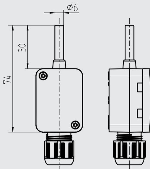
Modelo TF41 con sensor externo y protección solar
