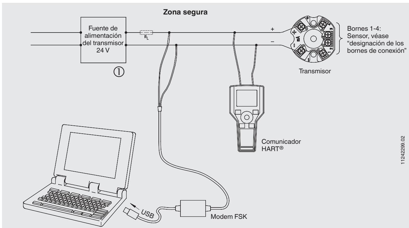
① RL = Resistencia de carga para comunicación HART®
