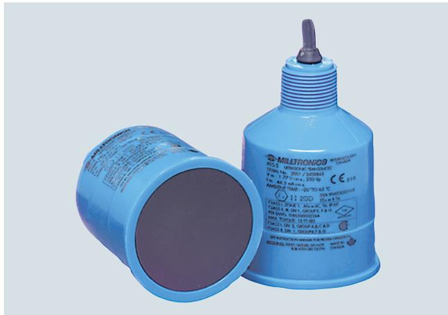
El sensor de ultrasonidos EchoMaxXRS-5 incorpora un ángulo de haz de 10° y una superficie emisora de caucho CSM para proporcionar medidas continuas fiables de líquidos y lodos. Es idóneo para estaciones y pozos de bombeo estrechos, canales, vertederos y lechos de filtrado.
