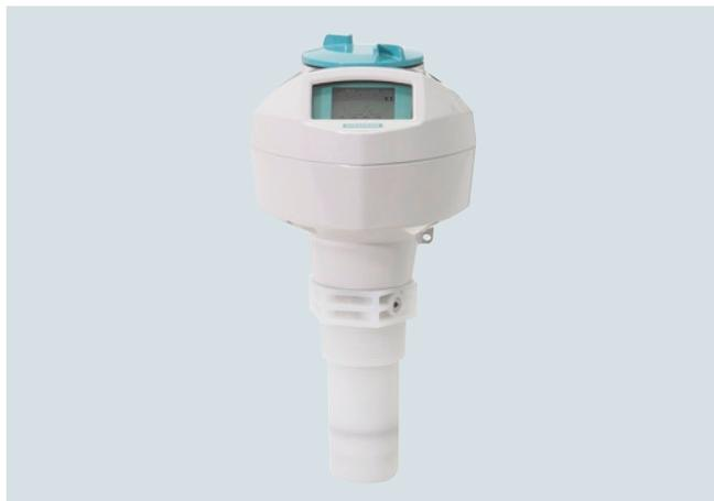
El radar pulsado a 2 hilos SITRANS LR250 con antena de PVDF roscada y frecuencia 25 GHz, mide el nivel de líquidos y lodos de forma continua en tanques de almacenamiento o de proceso, con materiales corrosivos o agresivos. El rango de medida alcanza los 10 m (32.8 ft) o 20 m (66 ft) en un tubo anti-oleaje.
