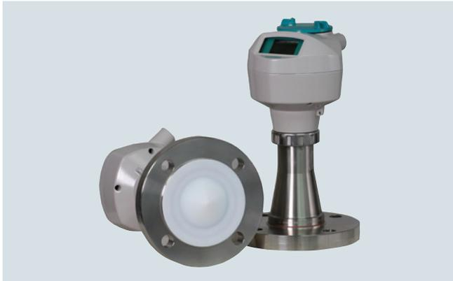
El radar pulsado a 2 hilos SITRANS LR250 con antena bridada encapsulada y frecuencia 25 GHz, mide el nivel de líquidos y lodos de forma continua, en tanques de almacenamiento o de proceso con presión y temperaturas extremas. El rango de medida alcanza los 20 m (66 ft) (depende del tipo de antena).
