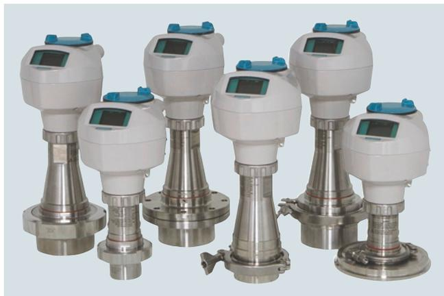
El radar pulsado a 2 hilos SITRANS LR250 con antena encapsulada, conexión higiénica, frecuencia 25 GHz y certificaciones sanitarias e higiénicas mide el nivel de líquidos, lodos y pastas de forma continua en el sector alimentación, bebidas, químico y los productos farmacéuticos, en rangos de medida hasta 20 m (66 ft) (depende del tipo de antena).
