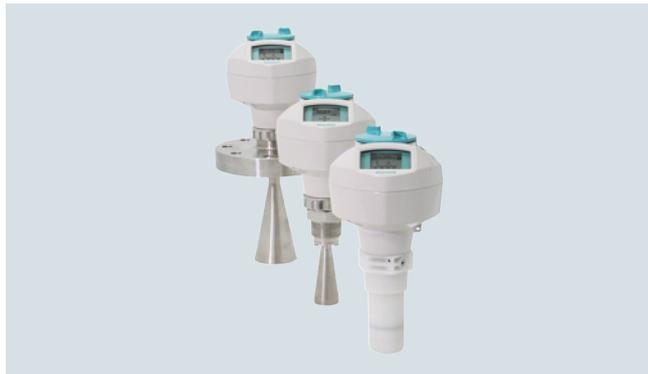
SITRANS LR250 es un transmisor de nivel radar pulsado a 2 hilos, frecuencia 25 GHz, para la medición de nivel continua de líquidos y lodos en depósitos de almacenamiento o recipientes de proceso. Apropiado para rangos de medida hasta 20 m (66 ft) y aplicaciones con presión y temperaturas extremas.
