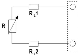
Éste es el método más sencillo. Las resistencias de línea  $R_{L1}$  y  $R_{L2}$  están conectadas en serie con el elemento sensible. El error de medición corresponde a  $R_{L1} + R_{L2}$ , debido a un decalaje entre la temperatura medida y la real. Debe evitarse este montaje.
