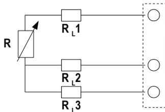
Éste es el método que implica 3 resistencias de línea  $R_{L1}$ ,  $R_{L2}$  y  $R_{L3}$  del mismo valor.  $R_{L2} + R_{L3}$ , permite medir la resistencia de las líneas que debe restarse al valor entre los bornes 1 y 2'. Éste es el montaje más usado actualmente.
