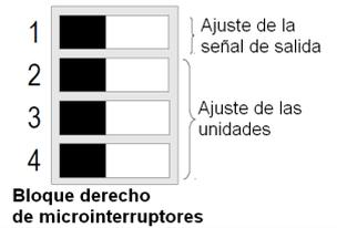
Compruebe la correcta selección de los interruptores según los esquemas indicados. Si por algún error se conectara uno de ellos de forma incorrecta aparecería en pantalla el siguiente mensaje: "CONF ERROR". En este caso sería necesario quitar la alimentación y posicionar los interruptores de la forma correcta.
