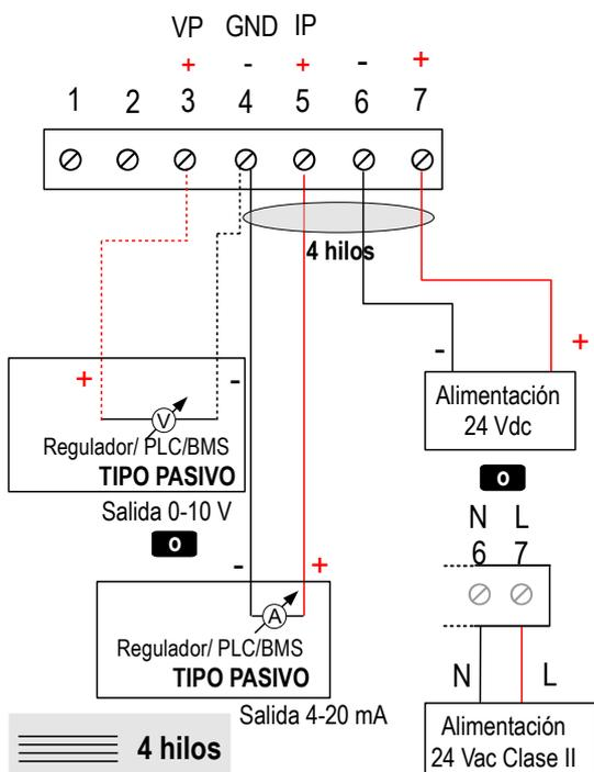
**⚠** EN LA CONEXIÓN A 3 HILOS, la interconexión entre las tomas a tierra (GND) de salida de señal y de alimentación debe realizarse antes de alimentar el equipo.
