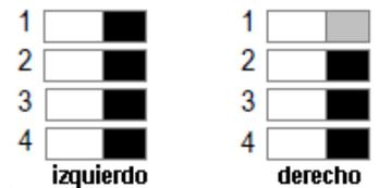
Posición para configuración con LCC-S
