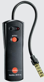
El detector de fugas de gases de combustión testo 317-1 localiza de forma eficaz los escapes de humos en unidades de calefacción. El práctico instrumento activa inmediatamente una alarma visual y acústica, haciendo innecesaria la inspección visual. El cuello maleable facilita el uso en puntos de difícil acceso.
