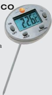
Después de medir, por ejemplo, en alimentos crudos o cocinados, el mini termómetro estanco se puede lavar directamente bajo el grifo o en el lavavajillas.
