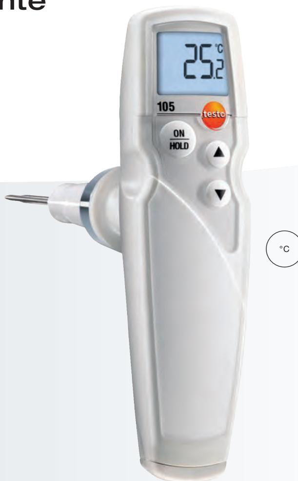
El testo 105 es un termómetro de gran robustez equipado con diferentes sondas para la medición de temperatura en medios semisólidos y una sonda para la medición en congelados. Gracias a la variedad de sondas, el termómetro es idóneo para su uso en aplicaciones gastronómicas, supermercados, cocinas industriales, cámaras frigoríficas o en el departamento de recepción de mercancías de cualquier industria alimentaria.
