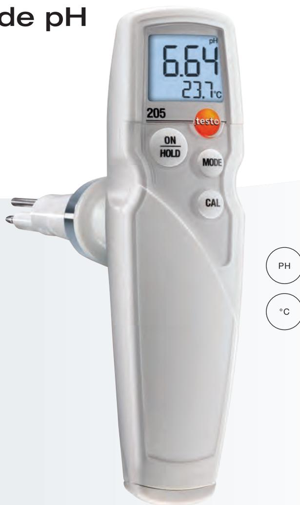
El testo 205 es un resistente termómetro de penetración para medir el valor de pH de los alimentos con compensación automática de la temperatura. La robusta sonda de penetración es reemplazable e insensible a la suciedad gracias al diafragma de poro único.
